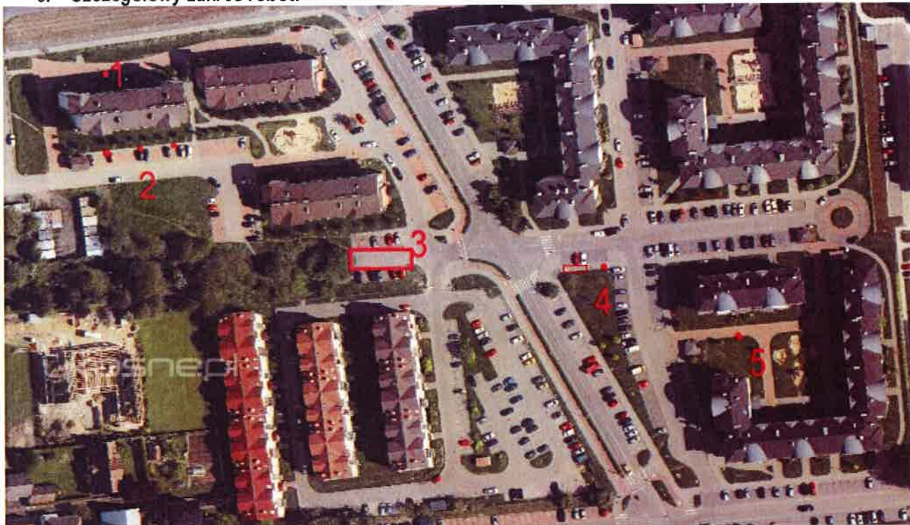
Rys.1. Lokalizacja miejsc wymagających przełożenia kostki brukowej – czerwonym kolorem oznaczono 5 miejsc, które wymagają naprawy chodnika/jezdni – ul. Koszalińska 23, 38/A1. Solidarności 2 w Opolu.
